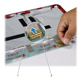
display cable 2 display cable connector
